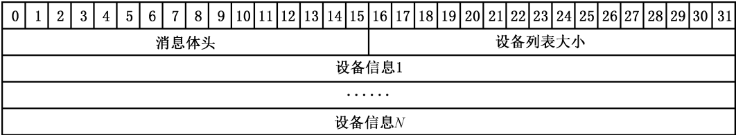
图 8 设备信息查询响应消息
