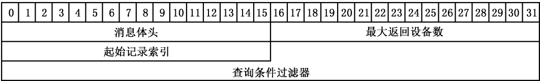
图 7 设备信息查询请求消息
