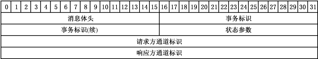
图 13 逻辑通道断开响应消息
