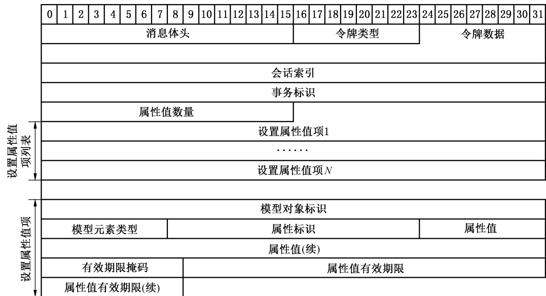
图 22 设置单个/多个属性值请求消息
