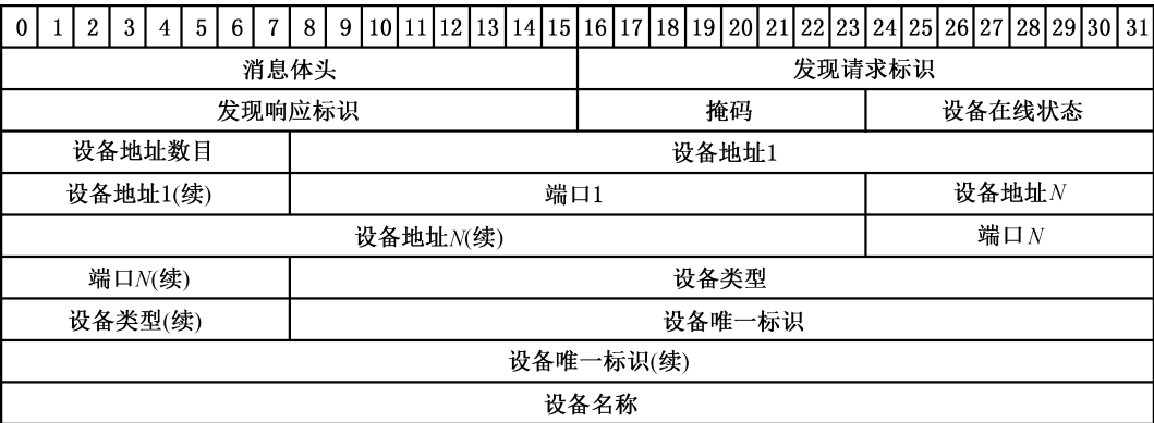
图 6 设备发现响应消息格式
