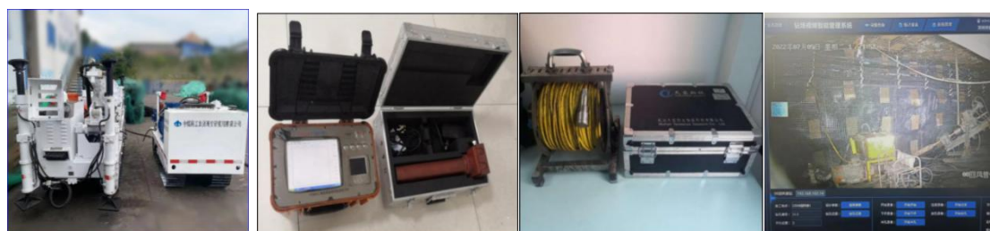
图 15 矿井部分水害防治装备和视频打钻系统
