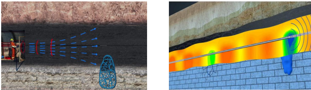
图7 孔中瞬变电磁探测示意图
