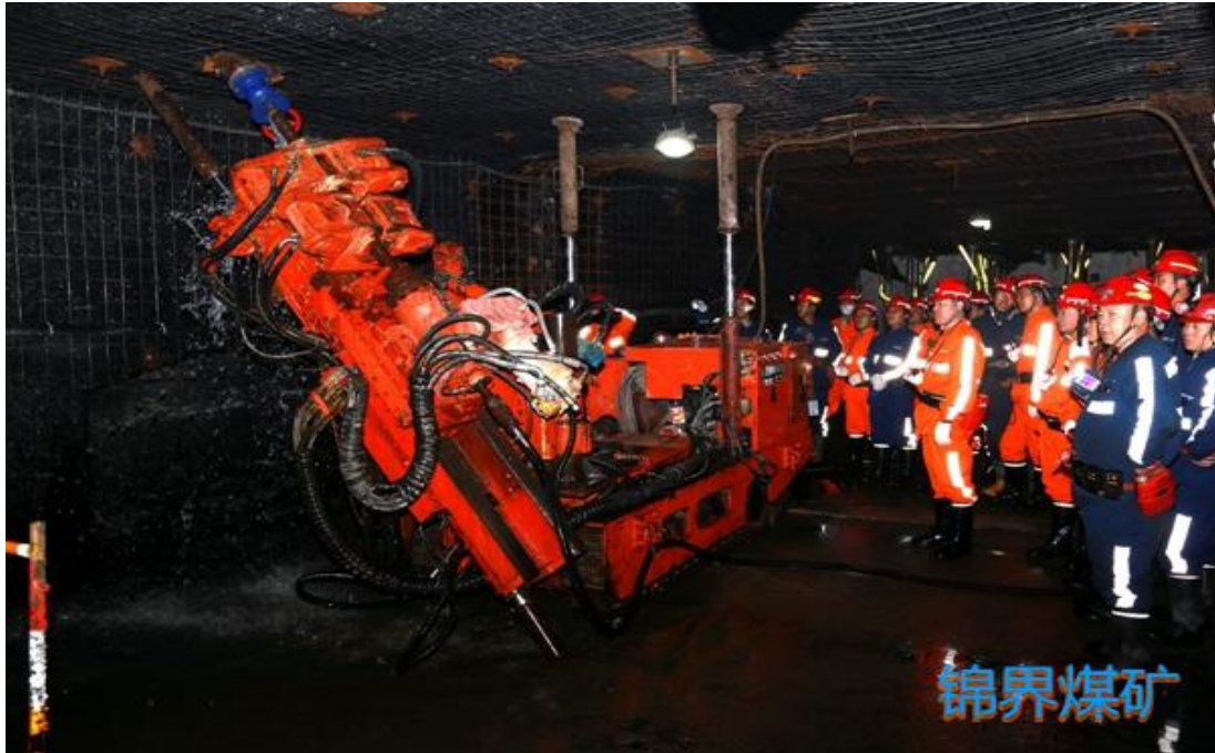
图 4：ZYWL-2000Y 全液压自动钻机施工现场
