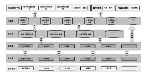
图 2 智能化矿山数据中台数据架构图
