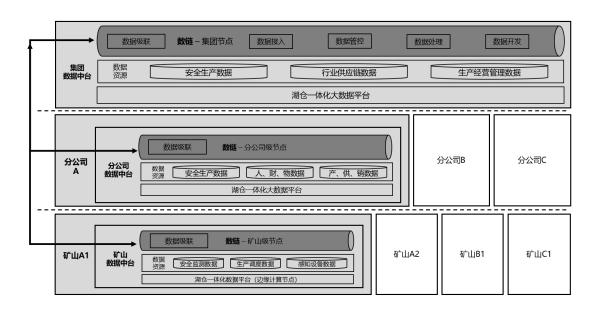
图 A.1 智能化矿山数据中台总体架构图
