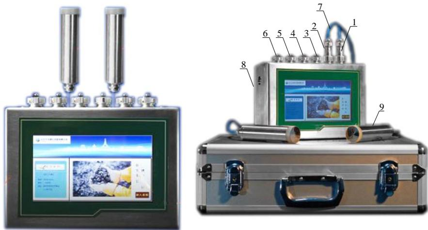
1一通道 2二通道 3三通道 4四通道 5数据传输接口 6充电接口 7电缆 8显示器 9感应电荷探头
