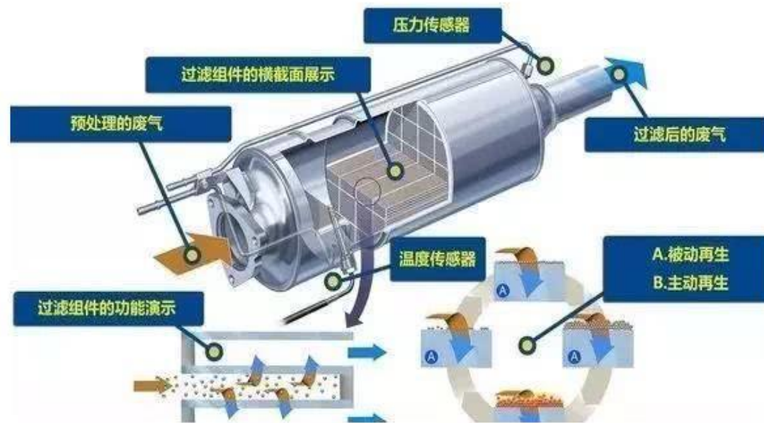
自主研发的氧化型催化器工作原理
