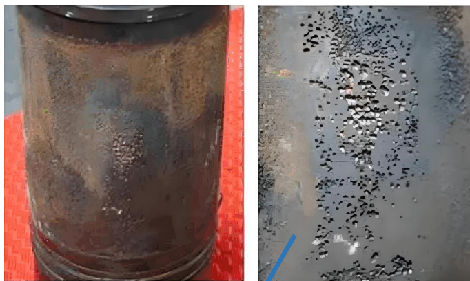
缸套穴蚀现象
