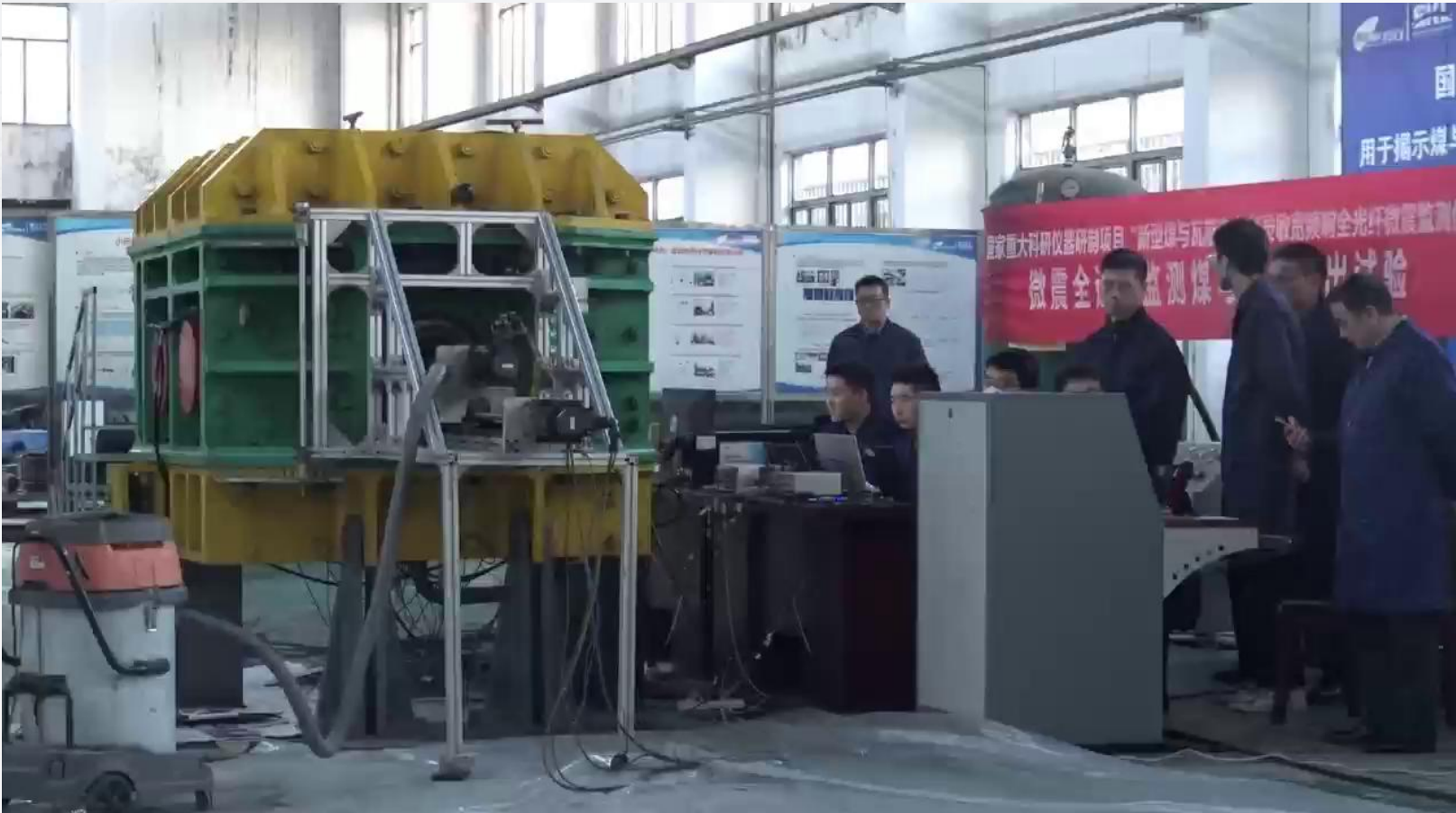
中尺度煤与瓦斯突出模拟试验现场
