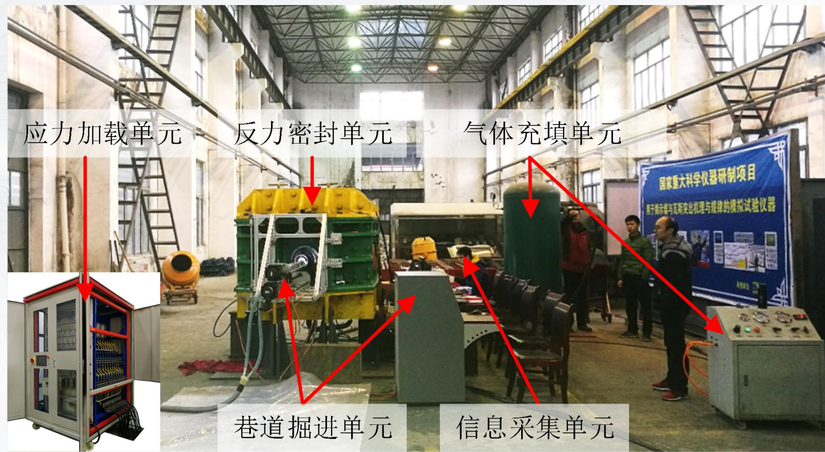
中尺度煤与瓦斯突出模拟试验现场
