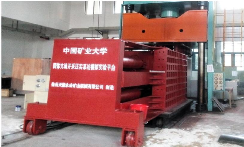
全尺寸多源煤基固废充填材料试验平台
