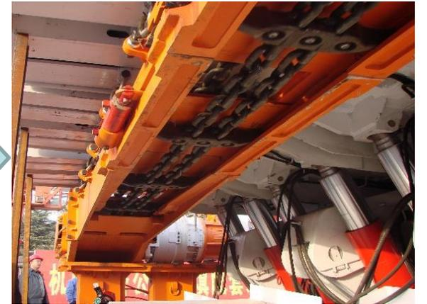
多孔底卸式输送机-物料输送
