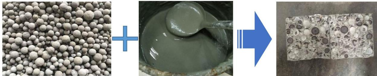
超细尾砂制粗骨料调配充填材料
