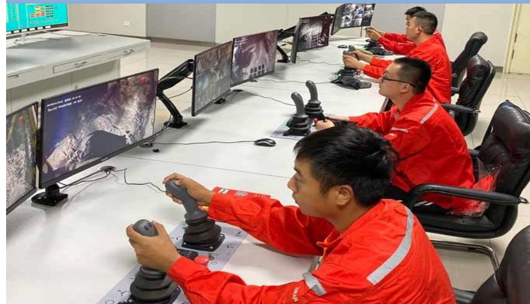
碎石机远程控制系统人员地表操作
