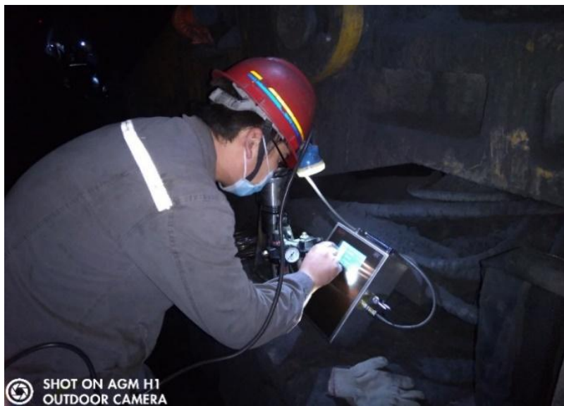
CWH12型煤层瓦斯含量测定仪井下应用现场
