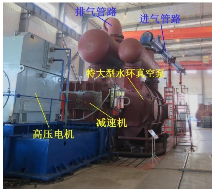
特大型水环真空泵测试现场照片
