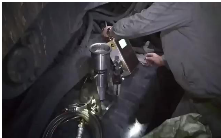
CWH12型煤层瓦斯含量测定仪井下应用现场
