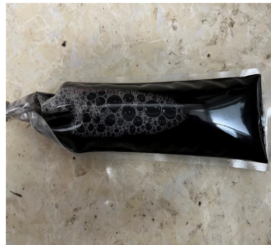
吕家坨煤矿CO消除悬浮液药卷及CO消除效果
