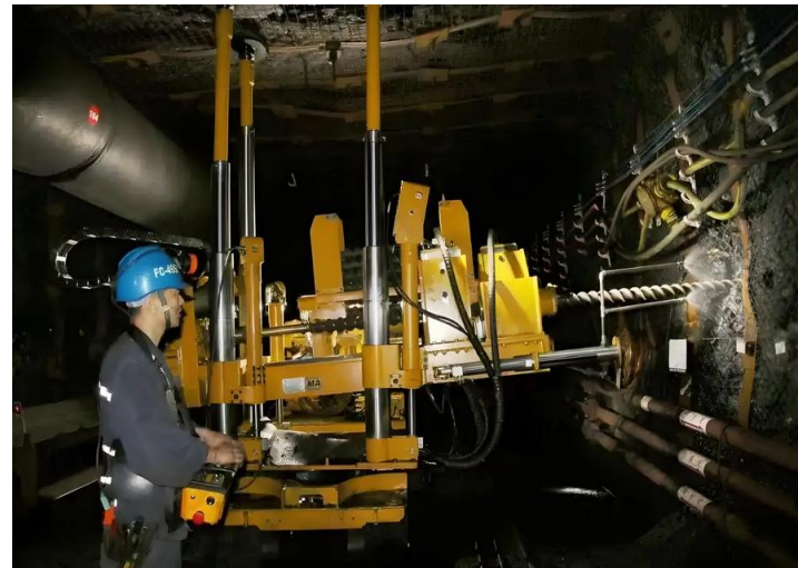
瓦斯含量测定井下打钻取样
