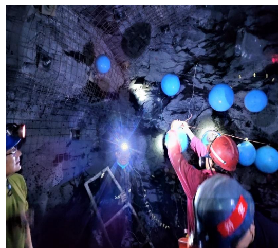
桑树坪煤矿消纳剂联用消除气球现场及CO消纳效果
