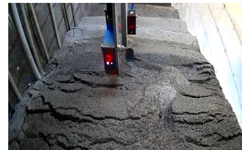
破坏阶段：坝体产生整体失稳破坏
