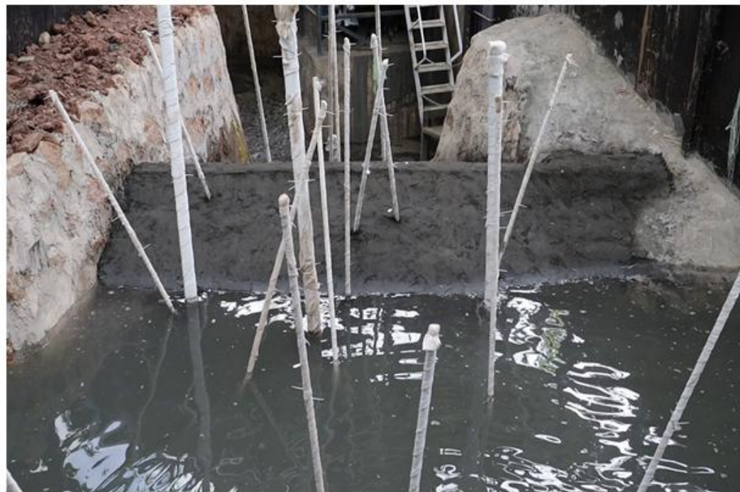
尾矿坝关渗透破坏溃口发展过程
