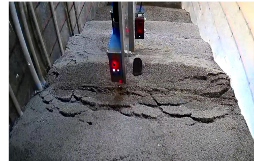
变形阶段：上部变形较大，产生多处破坏
