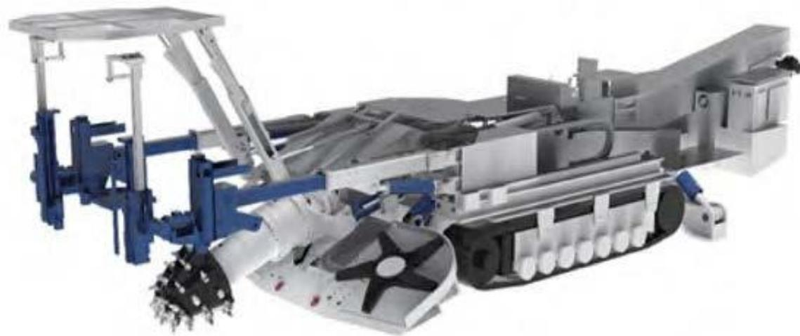
配有临时支护和锚杆钻机的掘进机
