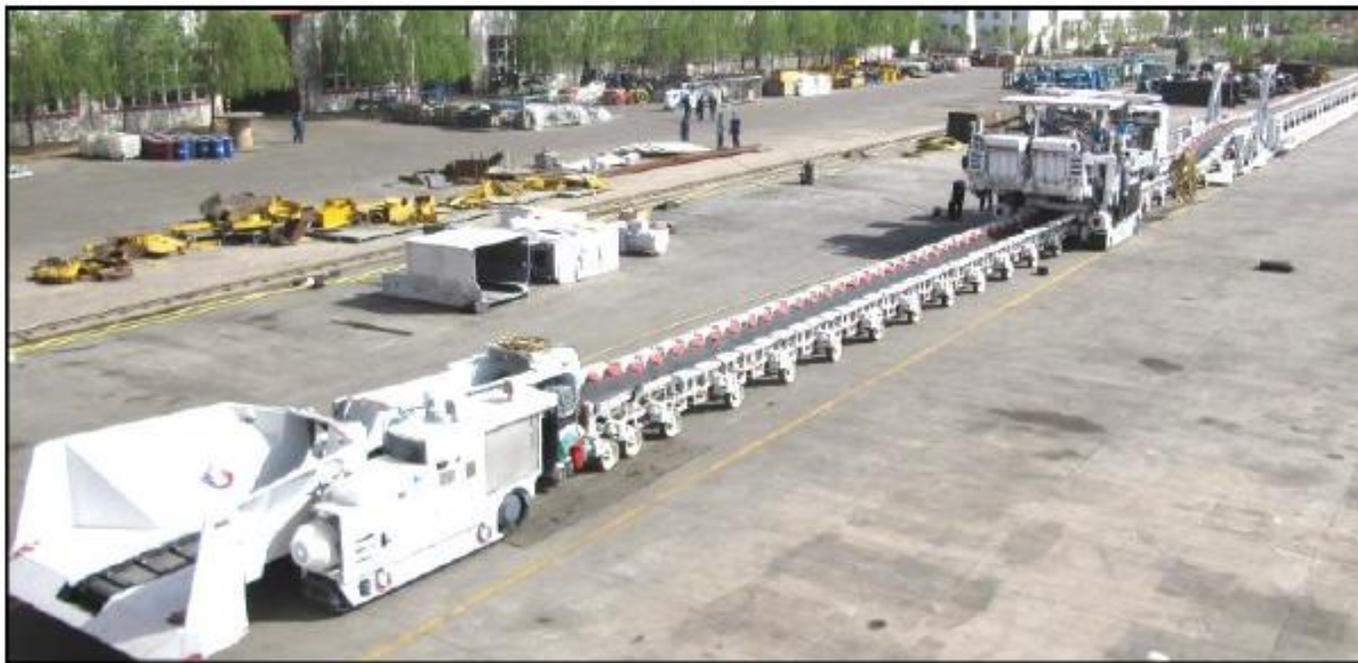
该套设备由太原研究院、北方重工、神东公司联合研发，包括全断面掘进机、跨骑式锚杆台车、破碎转载机、可弯曲胶带、自移动力站、迈步自移动式机尾等。神东大柳塔矿试验，日最高进尺 **132m**，月最高进尺 **3088m**。
