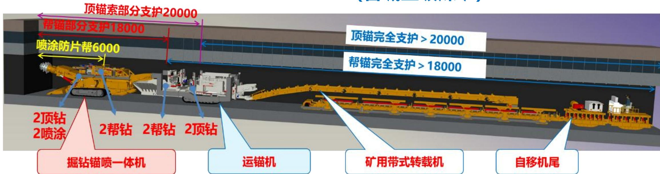
通过帮部喷涂形成临时支护，帮锚杆滞后打设，替代帮部金属网进而提高掘进效率
