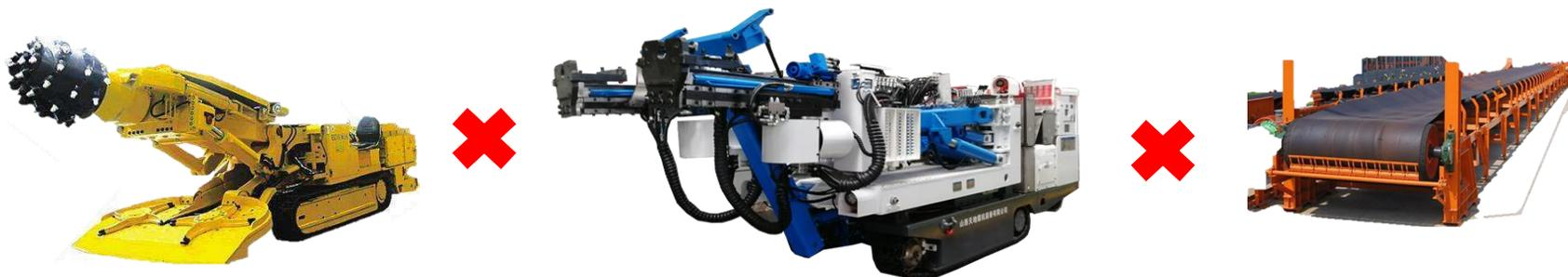
悬臂式掘进前进方向、截割路径规划、截割速度控制均依赖人工完成；支护由人工操纵单体气动锚杆钻机完成；掘进、支护、运输设备之间缺乏通信手段，协同作业能力较差。
