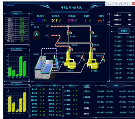
□ 瓦斯智能抽采管控系统，是针对煤矿井上下瓦斯抽采全周期进行管控的智能化系统，结合物联网、大数据分析和智能监测技术，将瓦斯抽采专家知识、技术经验转化为智能决策，辅助矿井瓦斯抽采安全管理。
