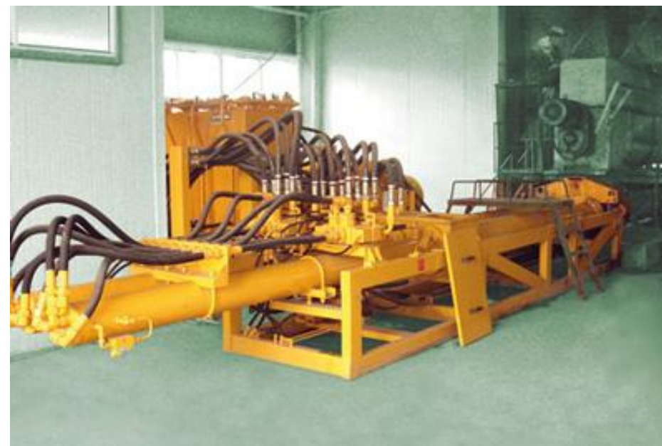
飞翼、Schwing、Putzmeister充填工业泵 最大能力400 m 3 /h
