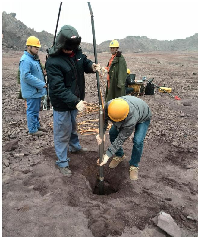
洞穴三维激光扫描仪
