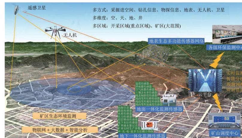
矿山生态修复监测监管大数据平台
