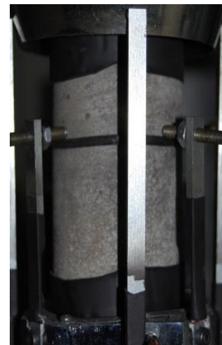
煤岩样单轴抗压强度试验典型试样破坏前后对比
