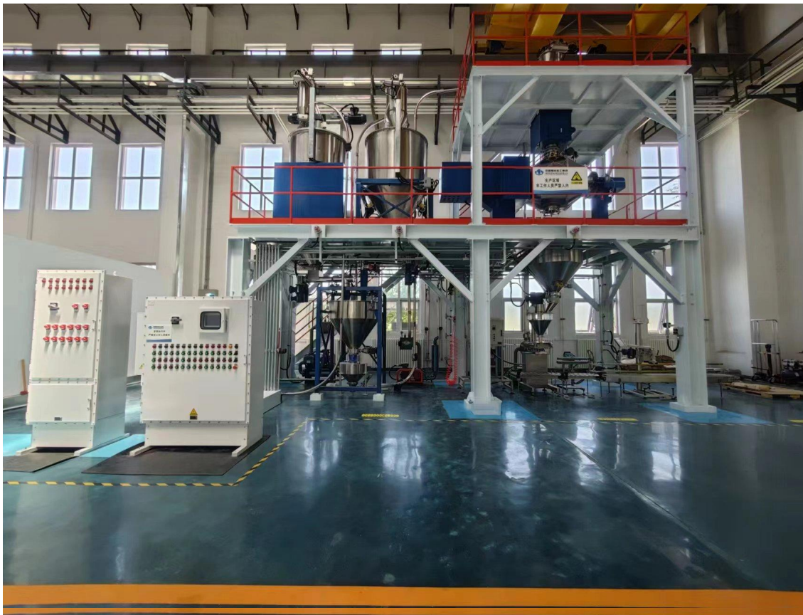
环保型相变凝胶钻孔密封材料自动化生产系统
