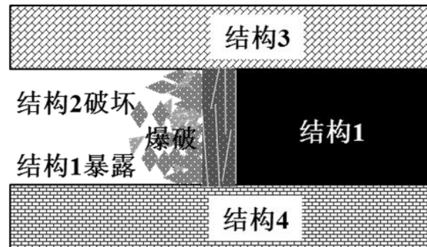
(c) 采掘作业一次性剥落结构2 (L-DL)
