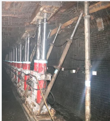
31103回风顺槽非回采侧帮肩窝单体加固示意图
