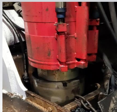
垛式支架：安全阀卸载值39.3MPa， 吸能装置动作压力值51.09MPa。
