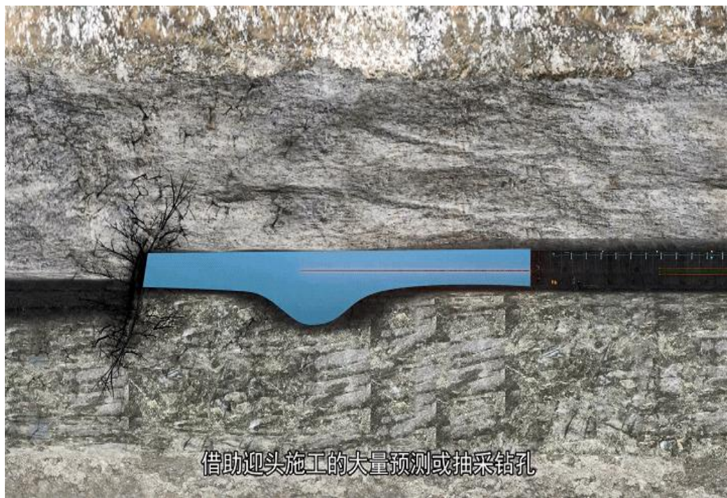
地质异常体超前钻孔雷达探测技术
