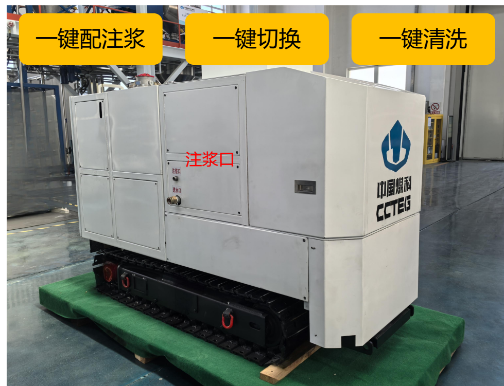
智能化配注浆封孔车
