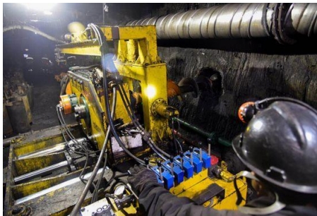
瓦斯治理钻孔施工
