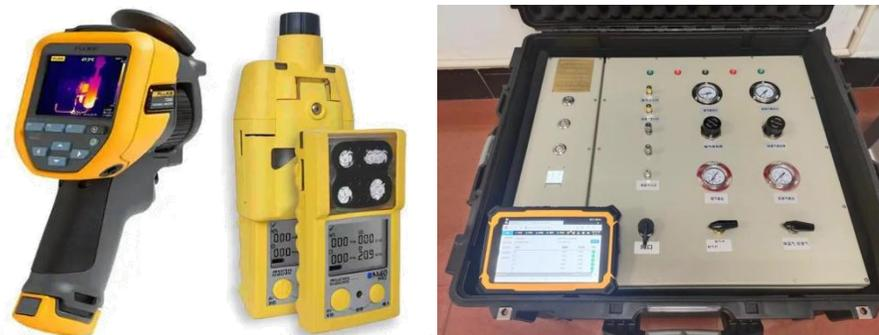
井下、作业现场：四合一便携检测仪、矿用本安型气相色谱（可入井）、热红外成像仪
