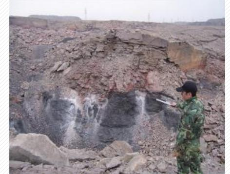
采用ZTR12地质雷达在内蒙古乌达煤田18#火区以及宁夏神宁集团白茆沟煤矿红湾新火区对地下煤火燃烧造成的塌陷破碎带进行探测，为灭火提供地质资料。
