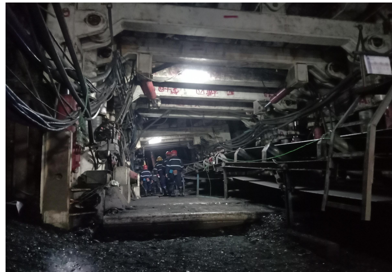
护盾式防冲击巷道支护装置现场效果
