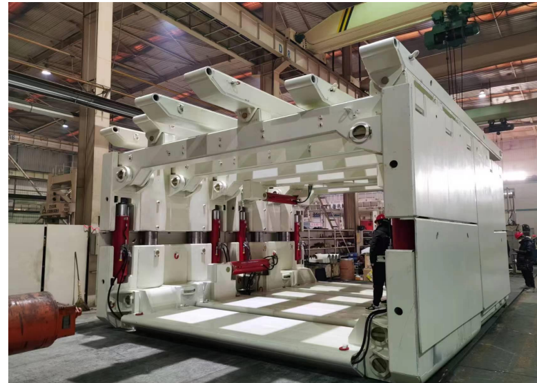
护盾式防冲击巷道支护装置
